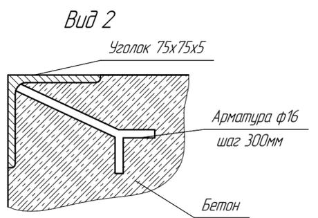
На данном эскизе изображена схема подготовки приямка и установки закладных элементов под уравнительную платформу с выдвинутой аппаратурой 1000 мм длиной 2500мм шириной 2000мм и высотой 700мм
